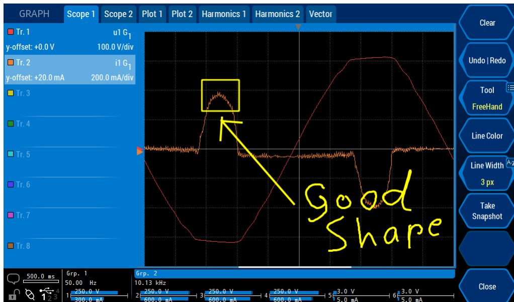
Abbildung 7.10: Der On-Screen-Painter. Es kann im über das On-Screen-Menü (siehe ON-SCREEN-MENÜ [7.1.1→151] geöffnet werden.)
