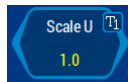
Abbildung 7.3: Softkey, der einen Zustand anzeigt. Die Stromskalierung ist 1.0. Durch Druck auf dem linken/rechten Softkey kann man diesen Wert in Stufen verändern. Ein langer Tastendruck öffnet in diesem Kontext einen Dialog zur Eingabe eines Skalierungswertes.
