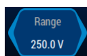
Abbildung 7.7: Ein deaktivierter Softkey, der trotzdem einen Status anzeigt. Das Verhalten ist ähnlich wie bei Abbildung 7.6 [→151], jedoch wird eine aktuelle Einstellung angezeigt. So etwas passiert häufig in Zusammenhang mit automatischen Funktionen. In diesem Beispiel ist die Auto-Range-Funktion aktiv, so dass man keinen Bereich von Hand wählen kann. Der Softkey zeigt trotzdem den aktuell eingestellten Bereich an.
